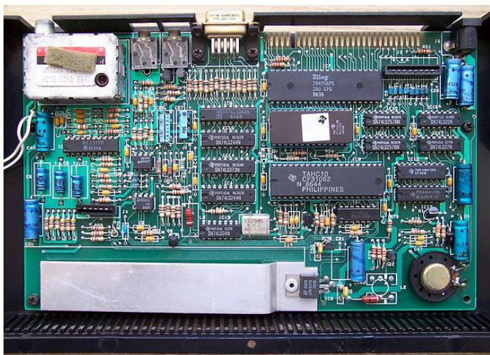
Scheda madre dello Inves Spectrum +. Notare le differenze rispetto alla scheda madre dello Spectrum Serie 3
