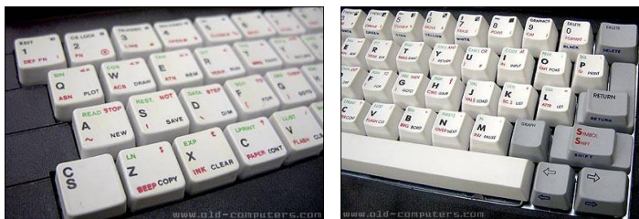
Confronto tra le tastiere dello HC91 a 40 tasti (a sinistra) e di quello a 50 tasti (a destra)
